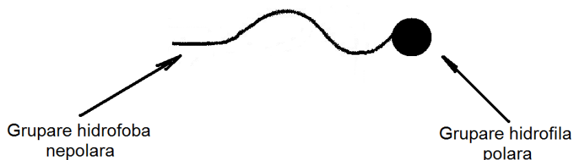
Fig.1. Reprezentarea convențională a moleculei unei substanțe tensioactive.
